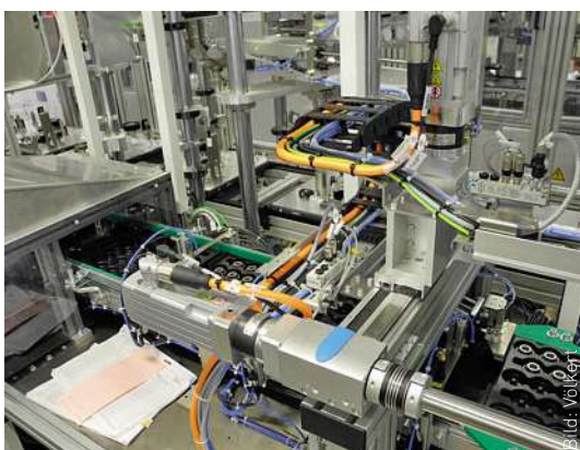
Zuführung der Dichtung der Wasserpumpe in Blistern, Einzelzelung über ein X-Y-Fächensportal mit Z-Hub-Greifer, Maschine während der Inbetriebnahme bei MP.
